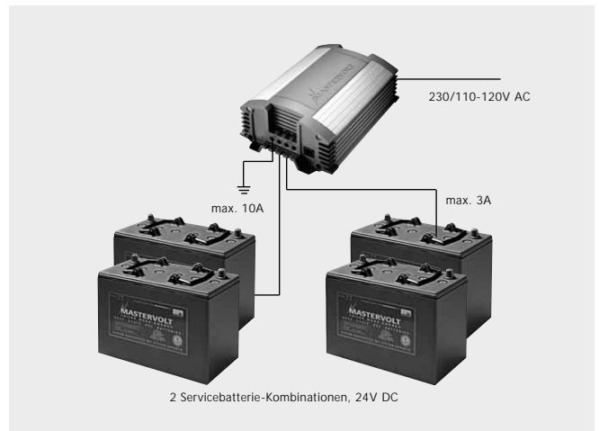
Der 24/10-2 mit einem Hochstromausgang und einem Nebenausgang.
